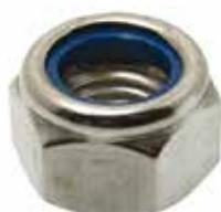
► L'écrou Inox indéserrable est conçu pour empêcher l'écrou et la vis de se désolidariser à l'usage. La bague interne en nylon se déforme autour des filets à mesure que l'écrou est serré sur la vis, assurant ainsi un serrage ferme, sans vibration sur la vis.
