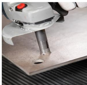
Lorsque l'amorce du trou est réalisée, relever progressivement l'outil à 90° par rapport aux matériaux
