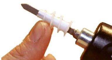
Insérer l'embout dans la visseuse, puis la cheville RAMTWIST dans l'embout
