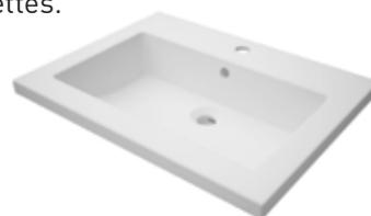
**Instructions de montage** : Prendre l'entr'axe de fixation des consoles sur le plan de toilettes et le reporter sur le mur ainsi que la hauteur désirée du plan de toilettes. Percer au Ø8, fixer les consoles sur le mur, positionner le plan de toilettes sur la console, serrer.
