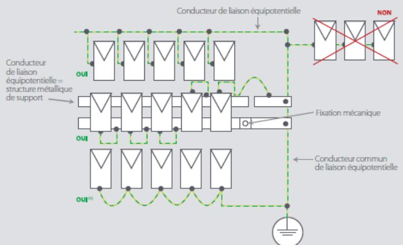
(1) : Dans cette configuration, un système permettant la continuité de la liaison équipotentielle dans le cas de maintenance d'un module doit être prévu. La liaison mise en place lors de l'opération de maintenance devra être d'une section minimale de 6mm<sup>2</sup> Cu ou équivalent.
